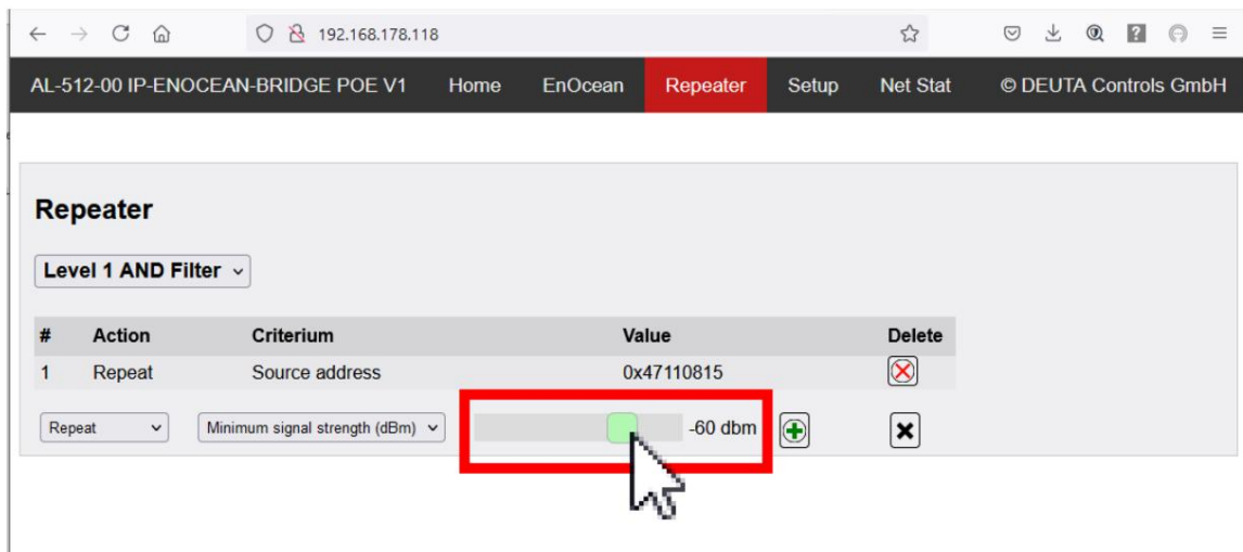
圖 5 :中繼器標準值信號強度
